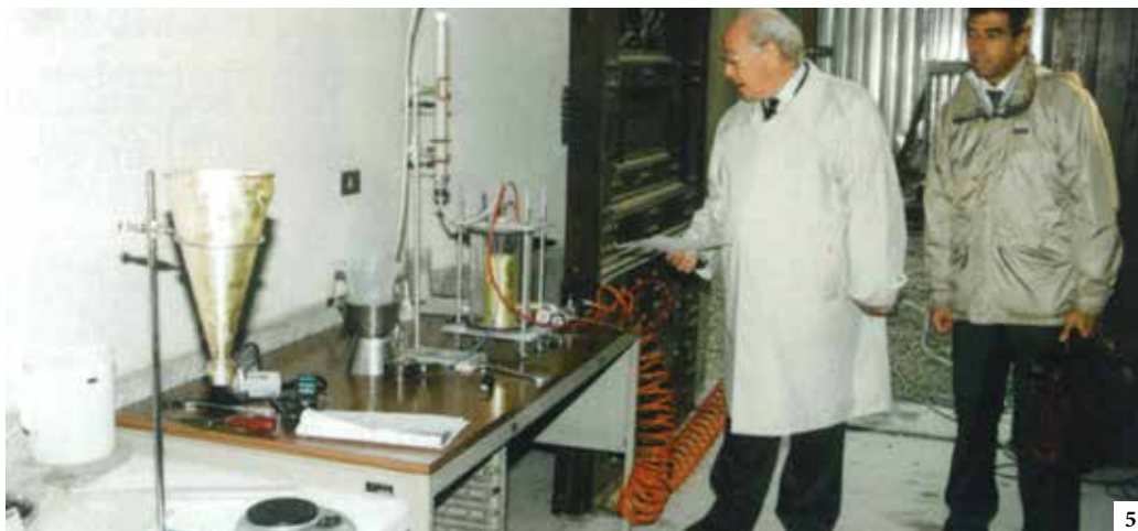
4. Ponteggio all'interno della cappella 5. Test in corso con l'apparecchiatura della colonna di sabbia
