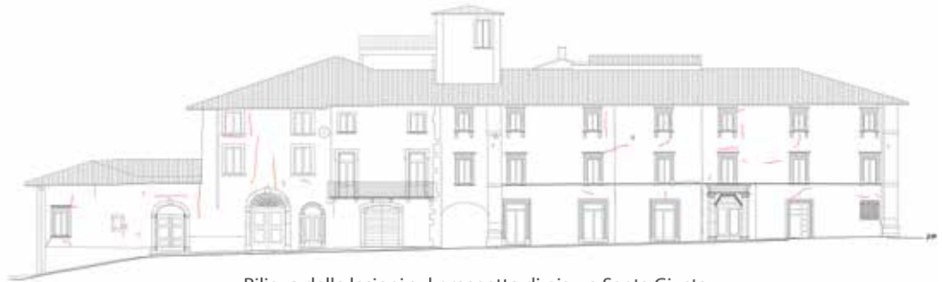
Rilievo delle lesioni sul prospetto di piazza Santa Giusta
